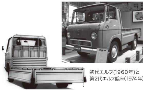
動の画期的超低床トラックから後輪小径タイヤでフラット低荷台が生まれ、配送車に革命的な変化を起こした。「エルフ死してエンジン残す」という伝説どおり、今もタイではエルフから取り外したクロマードライナーエンジンが渡し舟などで長生きしており、エンジンの信頼性・長寿命を証明している。その後、燃焼室は渦流室式から、更に直噴式に驚異的な進化を続けており、長年の連続トップシェアを継続している。
