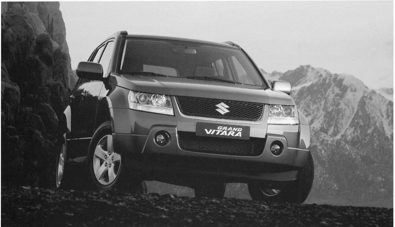
FRベースレイアウトを継承し、副変速機を備えた本格的4WDシステムを採用した「エスクード（輸出名：グランドビターラ）」
