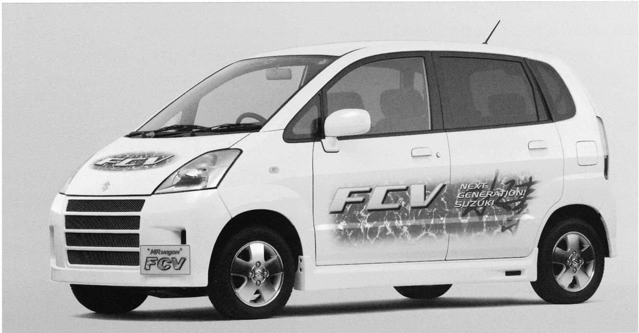
700気圧 圧縮水素貯蔵システムを搭載した軽自動車の燃料電池車「MRワゴンFCV」
