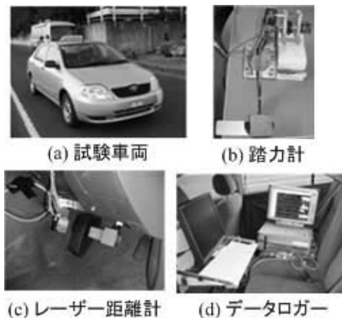
図3 実験車両および計測装置 Fig-3 Test vehicle and measurement tools
