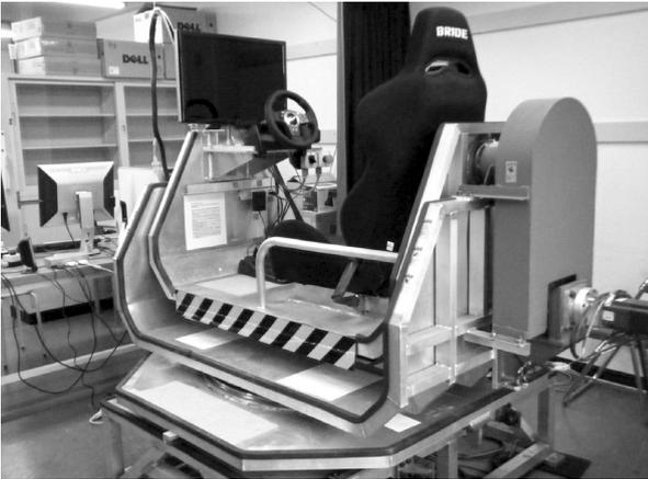
図1 ドリフトコーナリング対応ドライビングシミュレータ
