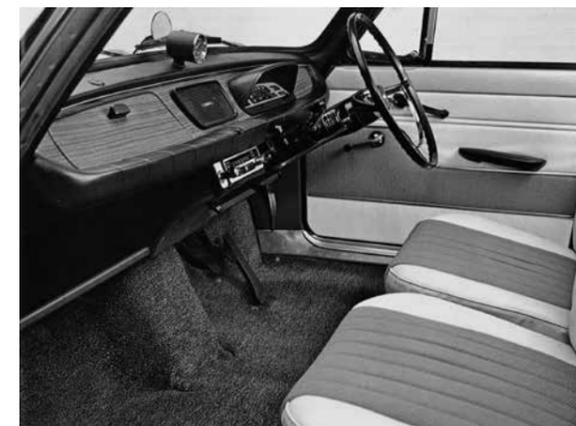
プロペラシャフトがないため可能となったフラットなフロア。これは後席も同様。ダッシュボードのデザインも室内広さに配慮しているが、市場からは殺風景との声があり、2回目のマイナーチェンジで、一般的な逆傾斜のデザインに変更された。後に追加されたフロアシフトモデルではコンソールボックスが設けられてフラットフロアが隠れた。
