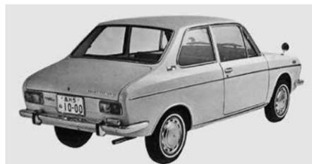
1967年2月に追加された2ドアセダン。同年11月にはこのボディに、高性能エンジンや強化サスペンション、ラジアルタイヤ(国産量産車初)、フロアシフト、タコメーター・3本スポークステアリングホイールなどの専用アイテムを装備した1000スポーツが登場した。
