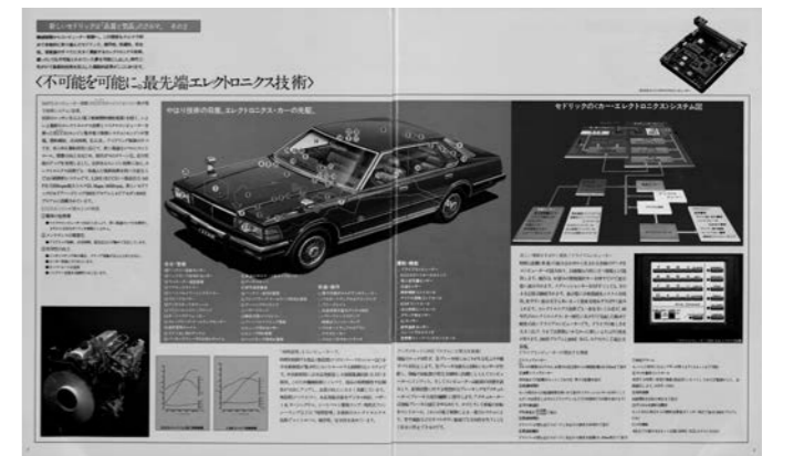
1979年発売のニッサン・セドリック/グロリアに初めて搭載された電子集中制御システム(ECCS)。燃料噴射、点火時期などを常に最適なレベルにコントロールして、各種性能向上に貢献した。
