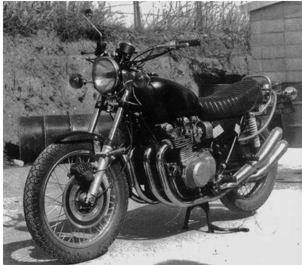
大槻が中心となって開発されたT-103。当時国内最大級となる900ccのエンジンは、空冷4気筒・DOHCで最高速度は230km/hを記録したという。このモデルが後に米国へZ1(900ccクラス)、国内ではZII(750ccクラス)と開発・発売されて圧倒的な人気を博した
