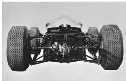
後輪ダンパーユニットはRA271のインボードを、整備性と軽量化でRA272では通常のアウトボードに変更していた。
