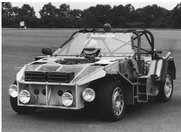
サスペンションの開発を目的に試作されたサスペンション・テスト・ベッド
