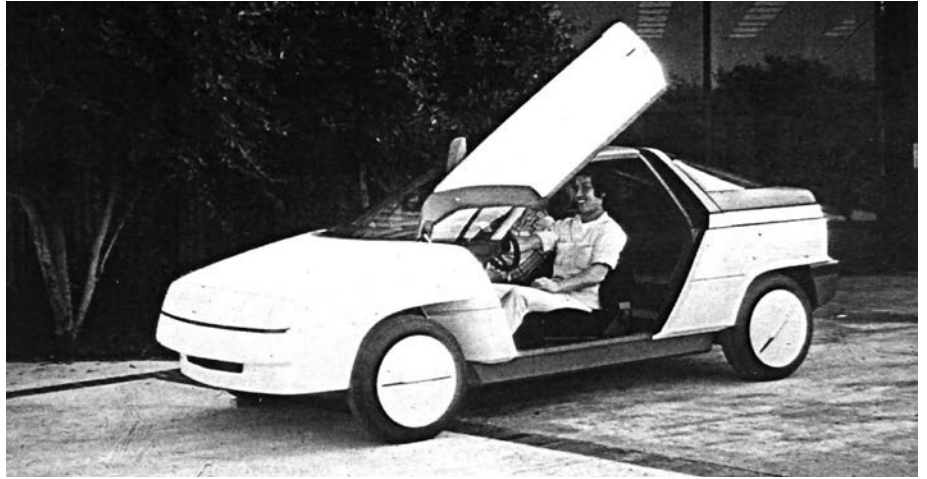
図-4 角材、スチレンボード、アルミパイプで作った簡易構造のモックアップモデル
