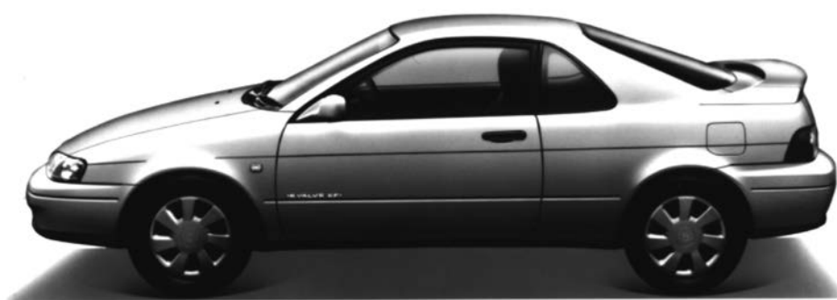
図-7 ターセルクーペ(日本名:サイノス)は、部品の共有化という会社からの要求に、低コストでセダンとクーペそれぞれのデザインを成立させた好例のひとつ
