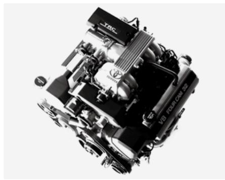
セルシオに搭載された1UZ-FE型3968cc V型8気筒DOHC32バルブ260ps/36.0kg-mエンジン。
