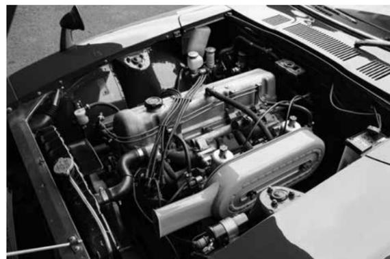
フェアレディ Z-L (1970 年式) に搭載された L20 型エンジン。直列 OHC、1998cc で最高出力は 130ps/6000rpm。
