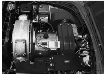
1軸式バッテリーハイブリッドガスタービン（左）と、これを搭載したトヨタスポーツ800（右）
