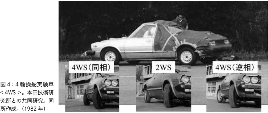
図4：4輪操舵実験車<4WS>。本田技術研究所との共同研究。同所作成。(1982年)
