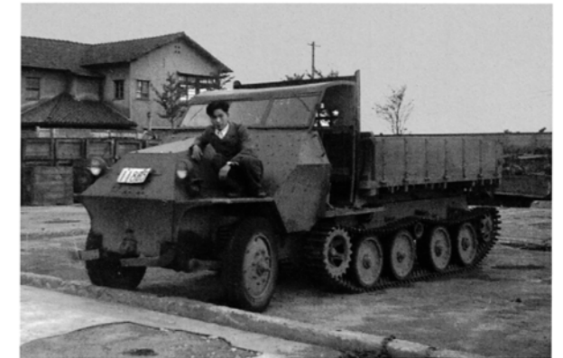
1 式半装軌兵員輸送車をトラックに改造した車(1945 年)。このキャタピラーを車輪に替えトラクターヘッドとし、トレーラーバス、トラックに変身させた。
