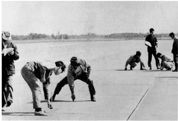
残跡装置により地面にしるされた走行軌跡のスケールによる計測風景 (US・OS試験、手放し方向安定性試験、高速安定性試験など)
