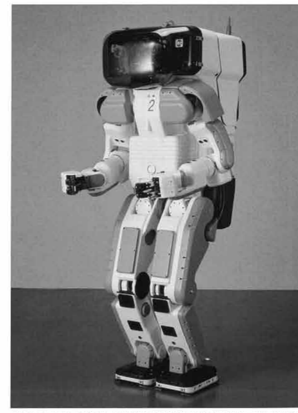
1996年12月に発表された世界初の人間型自律2足歩行ロボット「P2」
