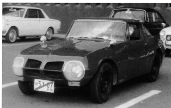
卒業設計で学生が製作したスポーツカー(1966~67年) スタイルデザイン、構造設計、FRPボデー製作、組付けまで全て学生の手で行われ、もの造りを体得する機会が与えられた。 ベースは、ダットサン フェアレディ1500 (SP310)。
