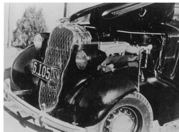
乗用車用ディーゼル機関6HSD9を搭載したビュック40型車
