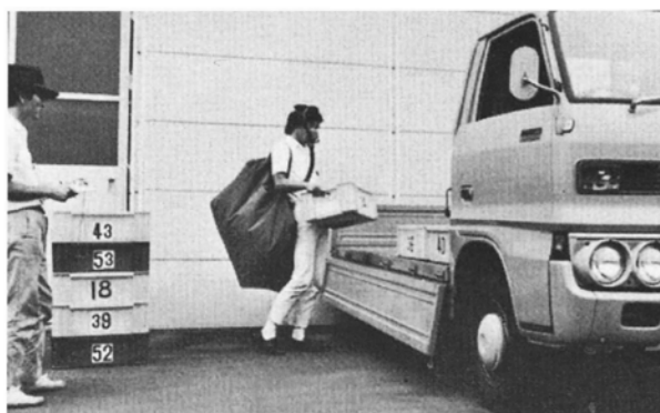
低い荷台の効果をエネルギー消費量測定で評価
