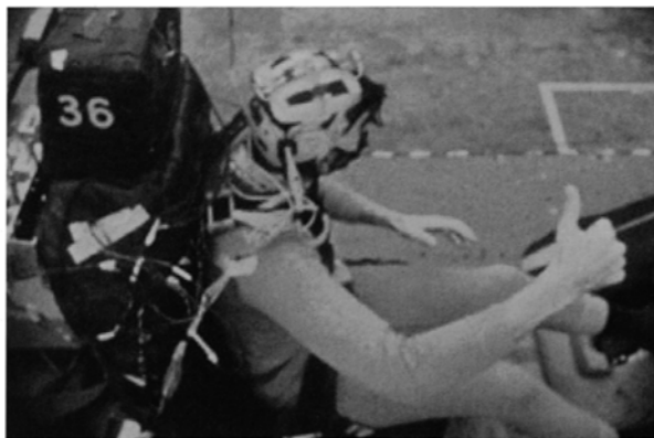
図5 タカタ製シートベルトが最高成績を記録した、ボランティアを被験者とする、NHTSA主催の時速30マイル(時速約48km)での衝突実験 1973(昭和48)年
