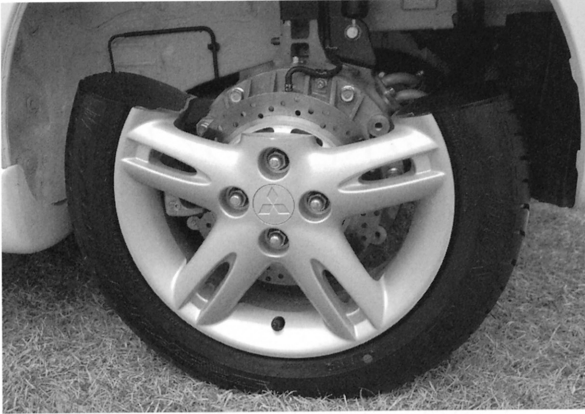
実験車コルトMIEVに搭載のインホイールモーター
