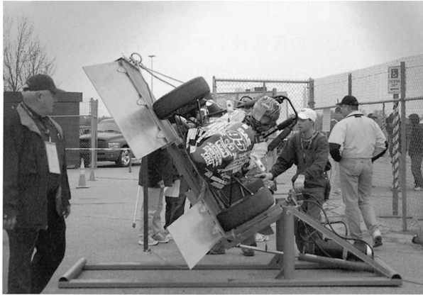
耐転覆性能確認のためのチルトテスト(2005年米国大会) 車両は安全上の幾つかのテストに合格しないと走行できない。 チルトテストでは、オイルと燃料の漏れがないことも確認される。
