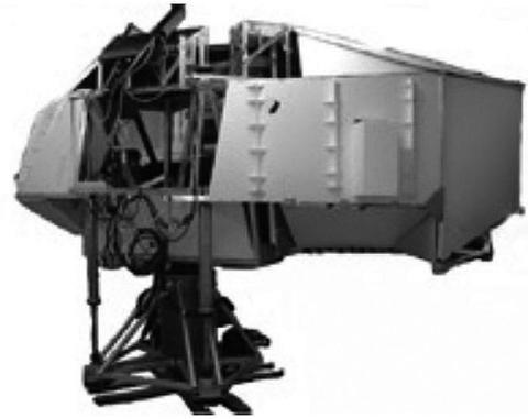
図3 ドライビングシミュレータ
