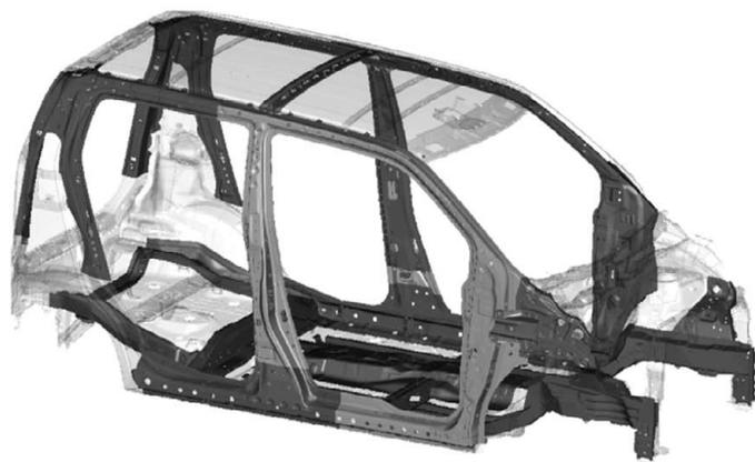
■ 超高張力鋼板 ■ 高張力鋼板
