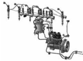
コモンレール式燃料噴射装置
