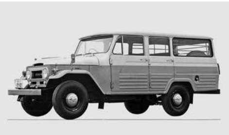
4 ドアステーションワゴン。国内向けカタログではライトバンとされているが、国際的にはステーションワゴン。1967年にこれに代わる専用ボディの55系が登場した。55系は60、80、100、200系へと続く。
