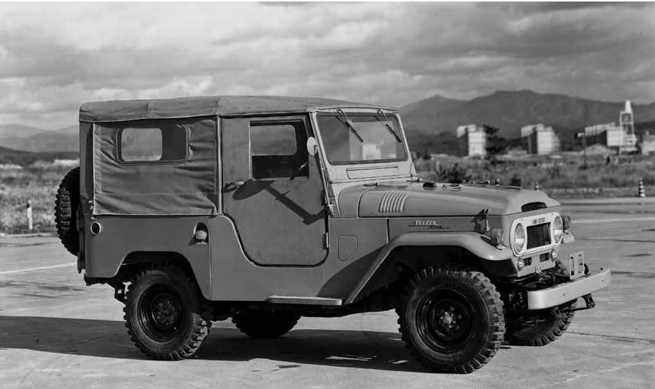
キャンバストップ。40系は先代の20系をベースに特徴のあるフロントグリルを採用したが、依然として機能優先のスタイル。リアシートは横向き対向ベンチシートで、荷物を積めるようにクッションは跳ね上げ式。
