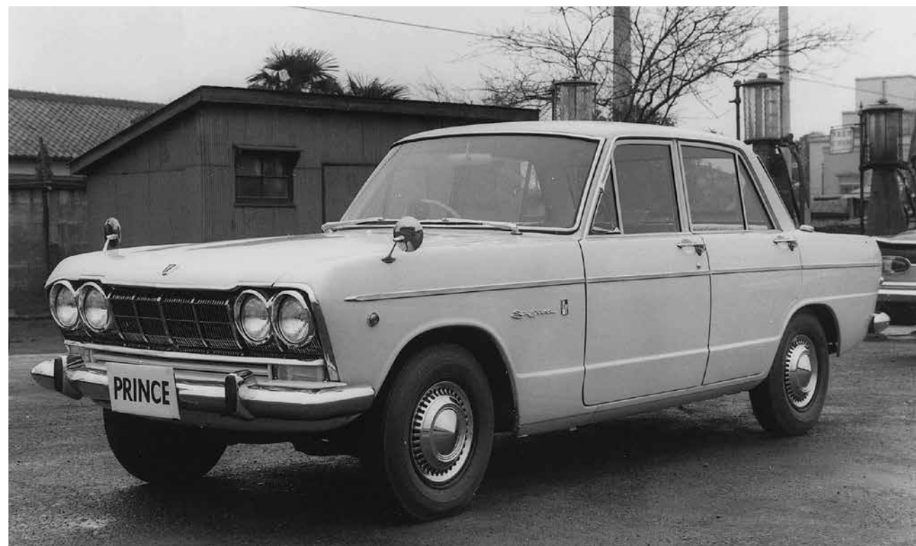
1964年5月に88万円で発売され「羊の皮を被った狼」と称されたプリンススカイラインGT。 長いボンネットの下には2ℓ 6気筒SOHC 105馬力エンジンが収まる。
