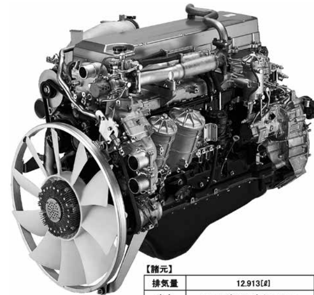
高出力ターボインタークーラ付エンジン E13C(2003年)
