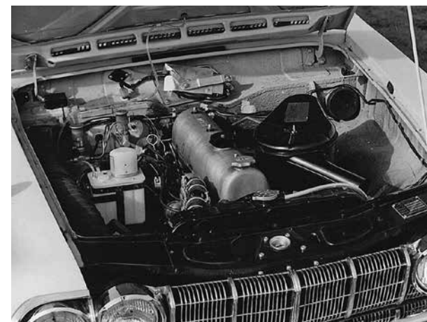
スカイラインGTのエンジンルーム。標準仕様はシングルキャブレターであった。
