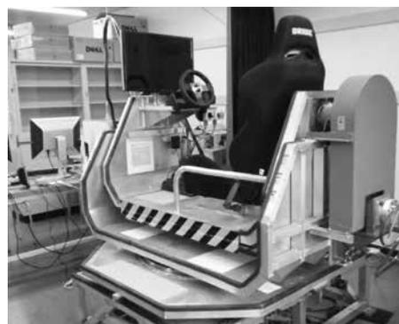
図1 ドリフトコーナリング対応ドライビングシミュレータ
