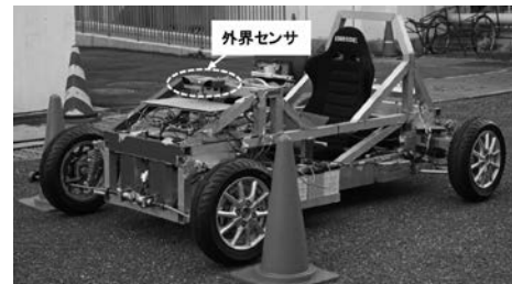
図17 製作した小型電気自動車(シャシーテストカー)
