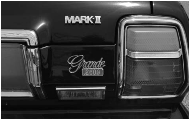
図4 マイナーチェンジされたリヤコンビネーションランプ
