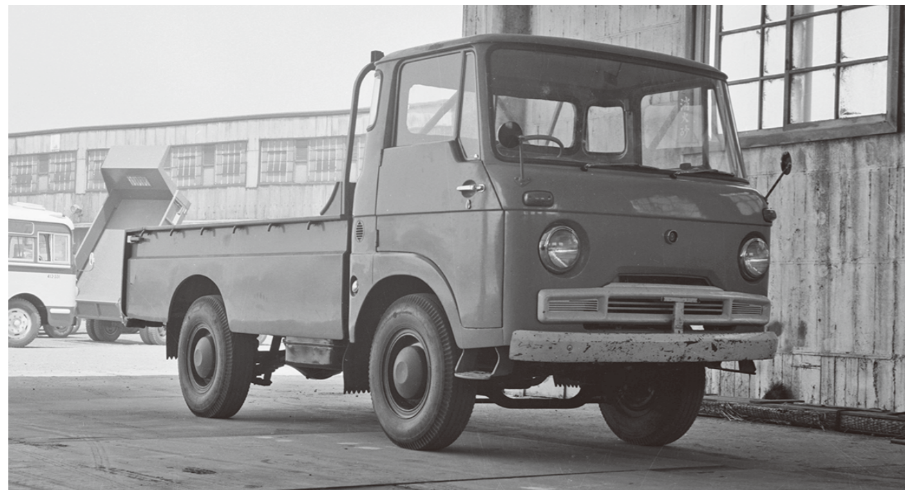
小型トラックのディーゼルエンジン化を決定づけた初代エルフ。1959年にガソリンエンジン搭載車として登場したが、デビュー翌年にDL200型2リッターディーゼルエンジンが追加された。
