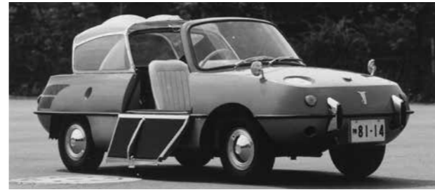
パイプフレームシャーシを製作しR360の足回りを組み付けキャロル600のエンジンを搭載したMK-600
