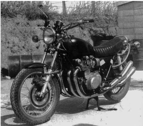
大槻が中心となって開発されたT-103。当時国内最大級となる900ccのエンジンは、空冷4気筒・DOHCで最高速度は230km/hを記録したという。このモデルが後に米国へZ1(900ccクラス)、国内ではZⅡ(750ccクラス)と開発・発売されて圧倒的な人気を博した
