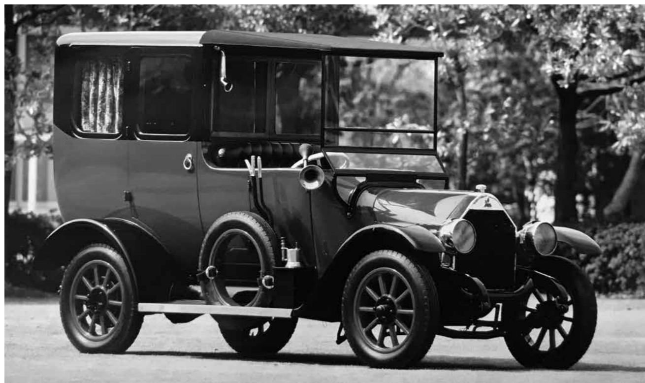
三菱オートギャラリー(愛知県岡崎市)には、三菱自動車工業(株)元常務取締役の中尾充夫氏が自動車評論家の五十嵐平達氏および池田英三氏の監修で、1972(昭和47)年にジープのシャシーとコルット1000のKE43エンジンをベースとして銭屋盛文氏に依頼し制作した「三菱A型レプリカ」が展示されている。
