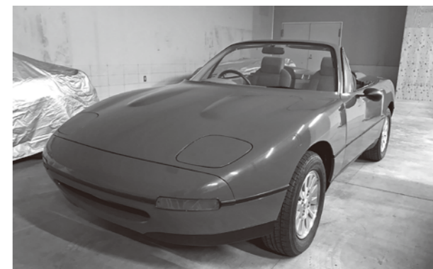
ロードスター誕生に大きな影響を与えた自走可能なプロトタイプ車。ファミリアをベースにして製作され、米国カルフォルニアの市街などを試走した。
