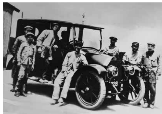
開発陣の写真。フロントウィンドの形状が変更。アセチレンガスポンベとガス燈、外側のレバーが見え、ナンバープレート付き。
