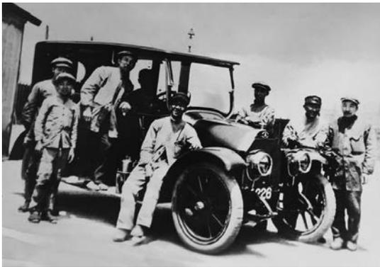
開発陣の写真。フロントウインドの形状が変更。アセチレンガスポンベとガス燈、外側のレバーが見え、ナンバープレート付き。
