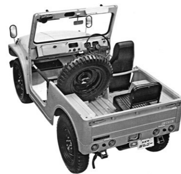
乗車定員3名のシートアレンジ。スベアタイヤは軽自動車の全長制限3000mmを守るため助手席後部に収めてある。
