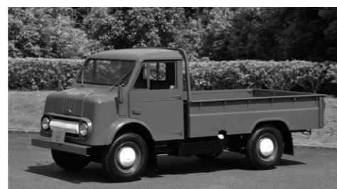
名称を公募して1956年7月以降の車名はトヨエースに。1958年に33psに出力アップ、価格46.5万円となる。荷台や燃料タンクのデザイン形状がスマートになっている。写真は愛知県のとヨタ博物館に所蔵されている1959年型。
