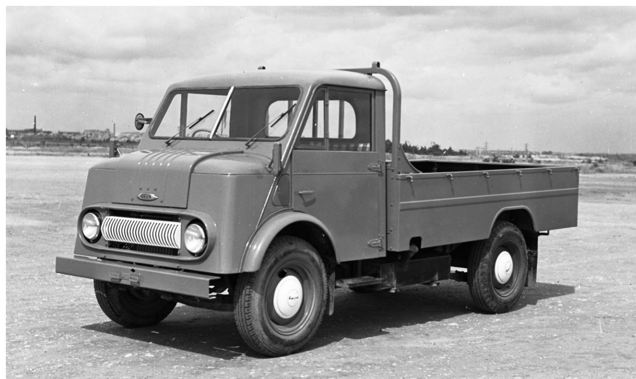
SKトラックベースで設計された初代SKB。平面フロントガラスに腕木式方向指示器など低廉にするための工夫が盛り込まれた。キャブオーバー採用で荷台も大きく、大柄な外観は威風堂々として街の商店主に愛された。
