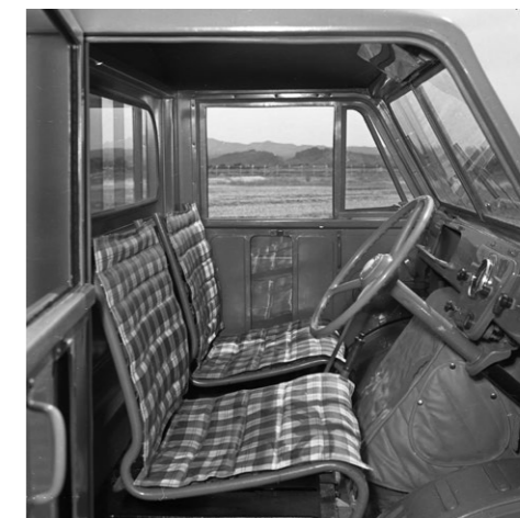
キャブ前部中央にエンジンが置かれる。路面からの振動を吸収するハンモック式シート、ドアウインドはコストを抑え試作時は前後スライド式だったが、量産は全解放の上下式を採用した。
