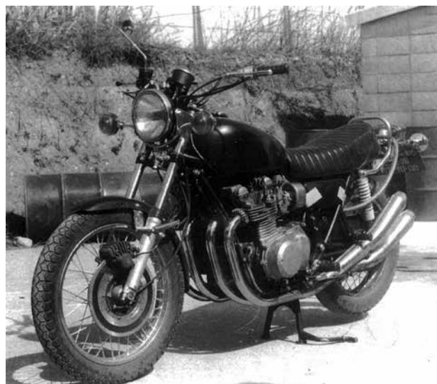
1970年に完成したZ1のテスト用試作モデルのT-103。この試作モデルは900ccクラスのエンジンを搭載し、テストコースでは230km/hで走行可能なことが実証された。
