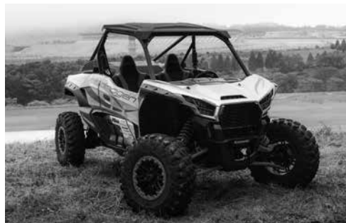
二輪車用水素燃料直噴エンジンを搭載した研究用バギー車
