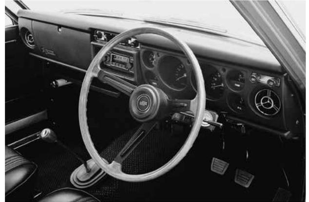
室内も外観同様、水平基調のデザインとし、インストルメントパネルにはソフトラッドを設け、安全対策を図っていた。
