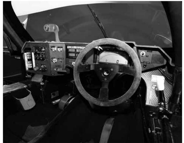
採用されたディスプレイは、データ収集システムも備え、テレメトリーシステムによって、エンジンの稼働状況をピットで待つエンジニアが目視できるようになっていた。
