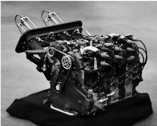
R26B型エンジンはペリフェラルポート吸気形式ながら、可変吸気、3プラグ点火、空燃比の最適化制御などにより、グループCレース専用車として過去最大の出力、最良の燃費性能となった。
